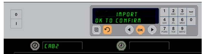
Les noms de fichier de configuration du matériel sur la clé USB sont visible sur le matériel (en haut) lors de l'importation d'une configuration. Pour sélectionner une configuration, appuyer sur le bouton de minuterie adjacent. Ce nom de fichier apparaît sur la position supérieure gauche (illustration du bas). Tous les boutons de minuterie sont éteints et toutes les autres positions de rangée sont vides.
